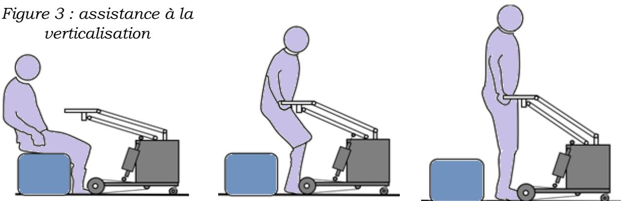
La fonction d'assistance à la marche est assurée par une plate-forme mobile équipée de deux roues motrices, qui assurent la propulsion du robot, et par deux roues orientables, qui garantissent la stabilité de l'ensemble.
