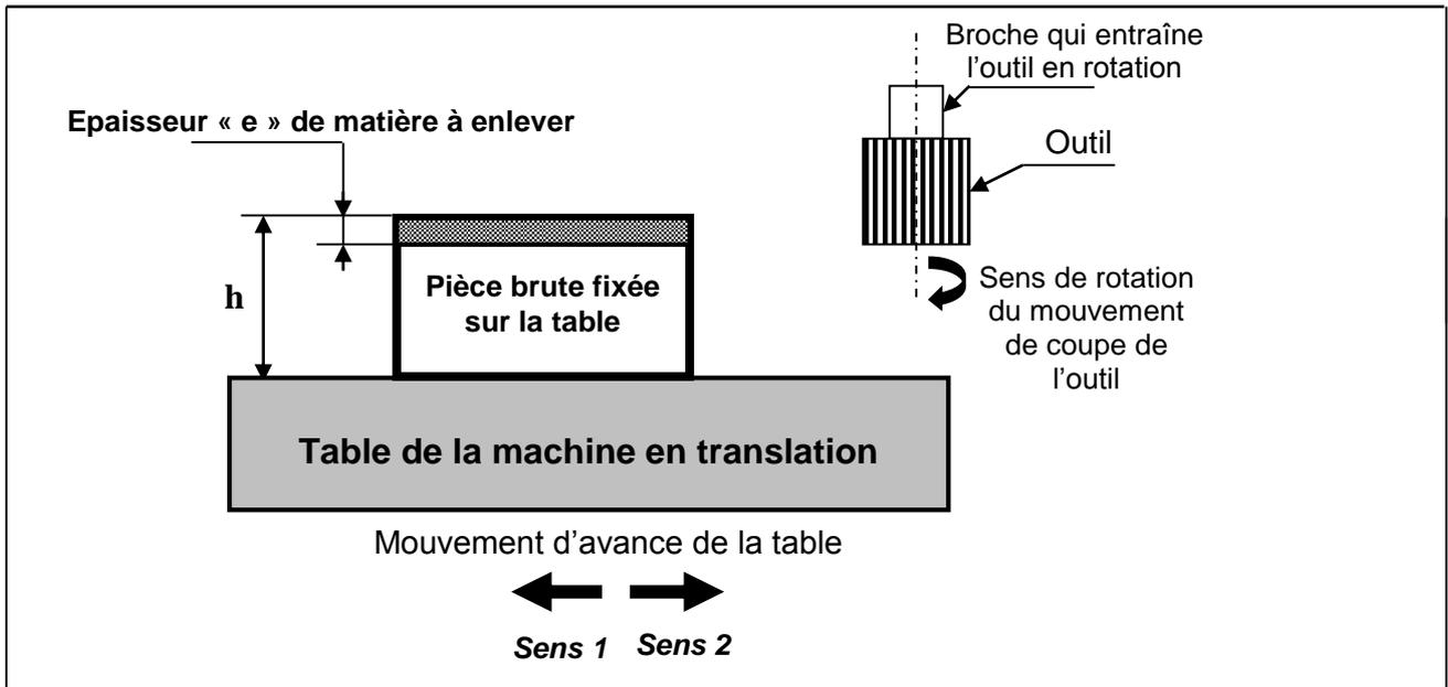
Après réglage des paramètres d'usinage et pour enlever l'épaisseur «  $e$  », deux mouvements sont indispensables : la rotation de l'outil autour de son axe (mouvement de coupe) et la translation de la table dans le sens 2 (Mouvement d'avance). A la fin de cette opération, la pièce usinée aura comme hauteur «  $h-e$  ».
