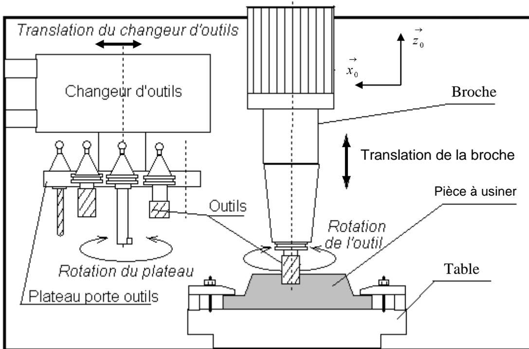
On souhaite développer l'exigence « " **Id 1.4** ": Enlever l'outil (1) », assurée en trois phases. Il est à **noter** que le changement d'outil ne peut être réalisé que lorsque le mouvement de rotation de la broche est complètement arrêté.
