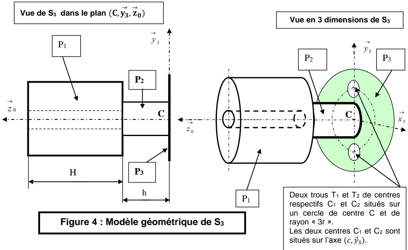
**Figure 4 : Modèle géométrique de  $S_3$**
